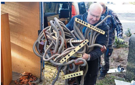
Nur ein Beispiel für die Herausforderungen, der Uwe Hardt beim Zusammenbau der Orgel in Lixfeld gegenübersteht: Dieses Gewirr an Luftschläuchen muss korrekt angeschlossen und dann auch noch verstaut werden. Foto: Sascha Valentini
